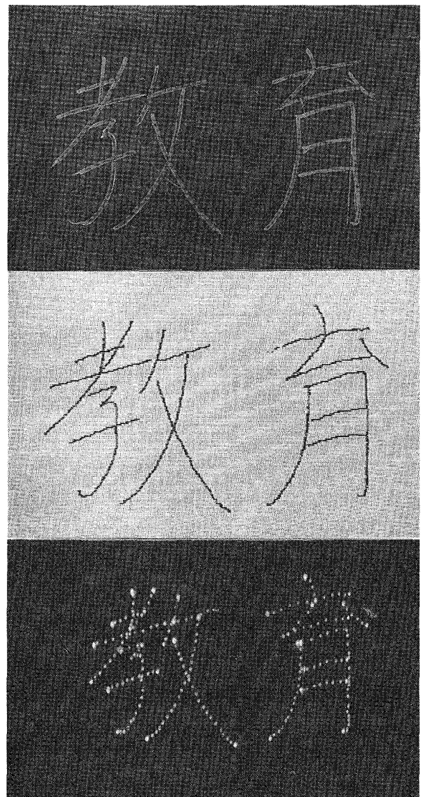
図-7 手書き文字「教育」のディスプレイ 上：タブレットに書いた文字 中：TVへのディスプレイ 下：オシロスコープへのディスプレイ
