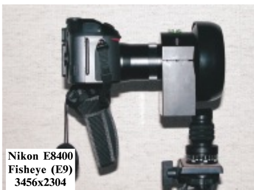
図2 既製品の専用パノラマヘッドとローテーター コンパクトデジタルカメラと魚眼レンズ・アダプター と専用のパノラマヘッドとローテーターの既製品
