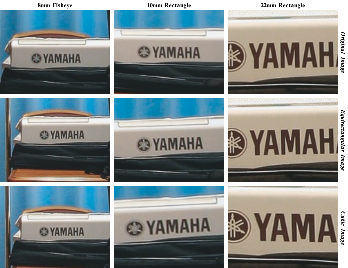
図8 広角レンズでの解像度の比較
