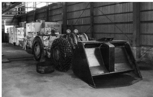
写真 11：ロードホールダンプ（前面）
