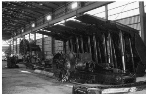
写真 12：自走枠（採炭機械）
