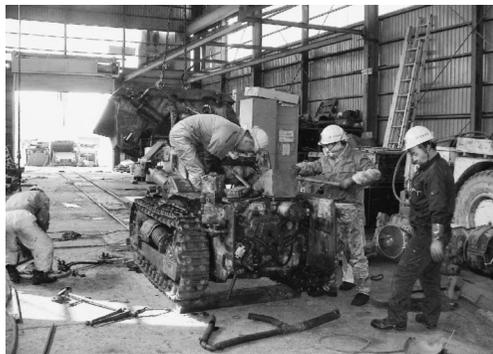
写真3：組み立て作業（ロードホールダンプ）
