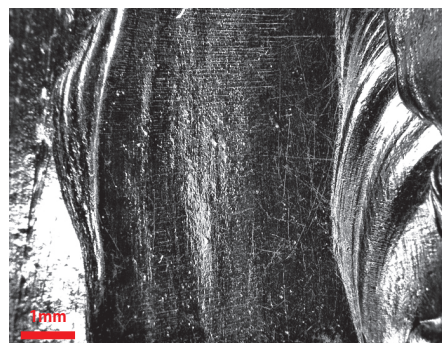
報図 18-6 写真 9：ランダム線状痕(弱)、線状痕(平行)
