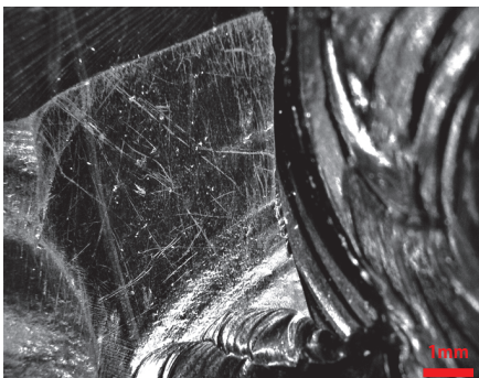
報図 18-6 写真 6：線状痕(平行・斜交)、ランダム線状痕(中)
