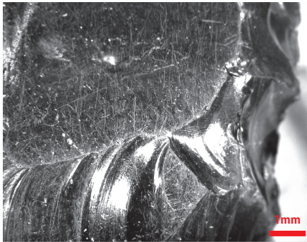
報図 18-1 写真 4 拡大: 線状痕 (平行)、ランダム線状痕 (中)
