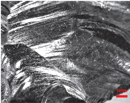
報図 17-13 写真 2: 線状痕 (平行)・ランダム線状痕 (弱)
