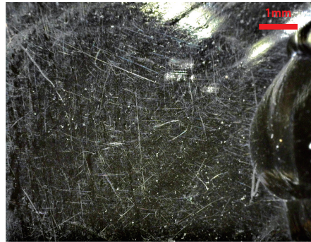
報図 18-10 写真 1 拡大: ランダム線状痕(中・弱)、線状痕(直交)
