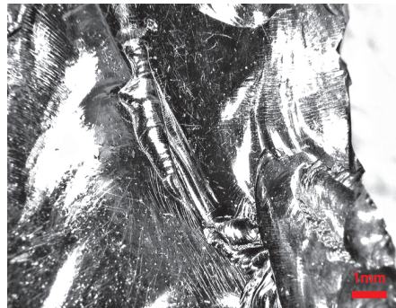
報図 17-15 写真 3: ランダム線状痕 (弱)
