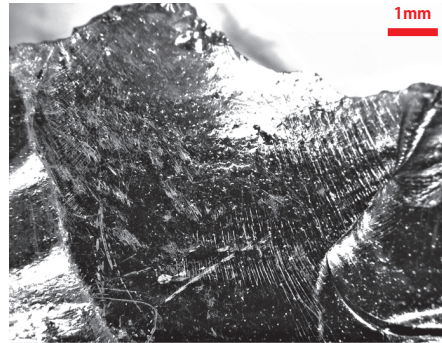
報図 46-4(18-4) 写真 16：ランダム線状痕(弱：擦れ状)
