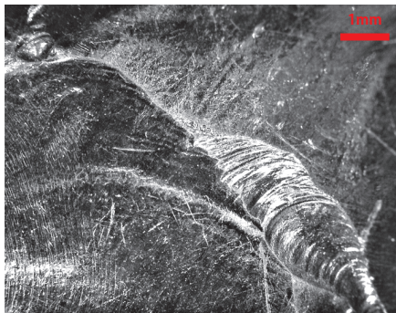
報図 46-2 写真 1：ランダム線状痕(弱・中)
