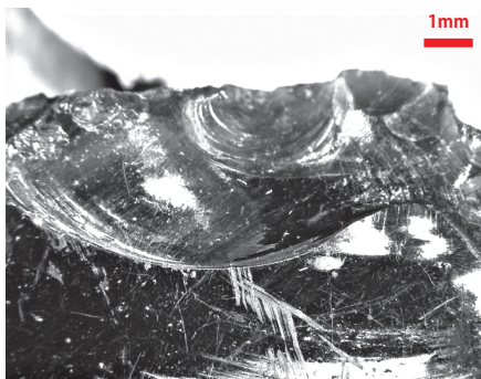
報図 19-11 写真 1：ランダム線状痕(弱・中)
