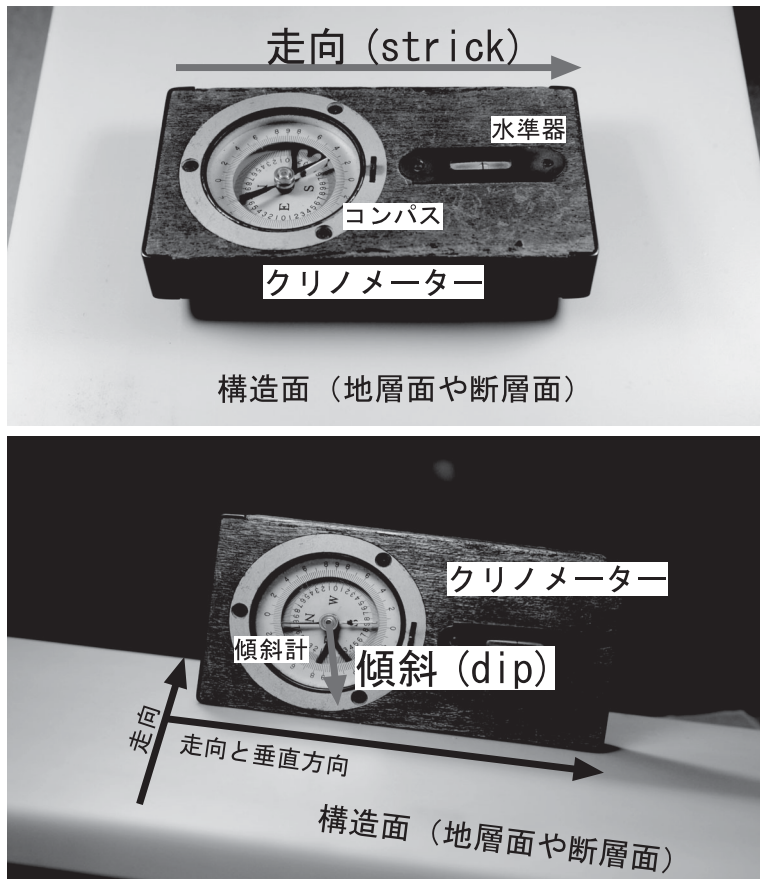
図4 クリノメーターの使用方法
