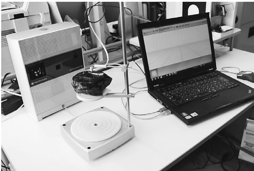
図1 NextEngineを用いた計測
